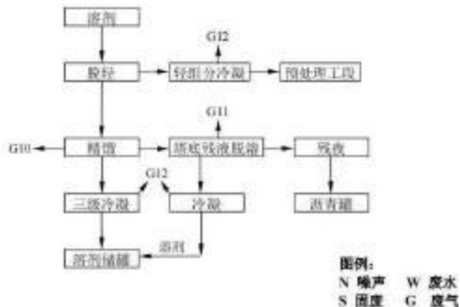
图 4.1-4 溶剂再生工段工艺流程及产污节点图
