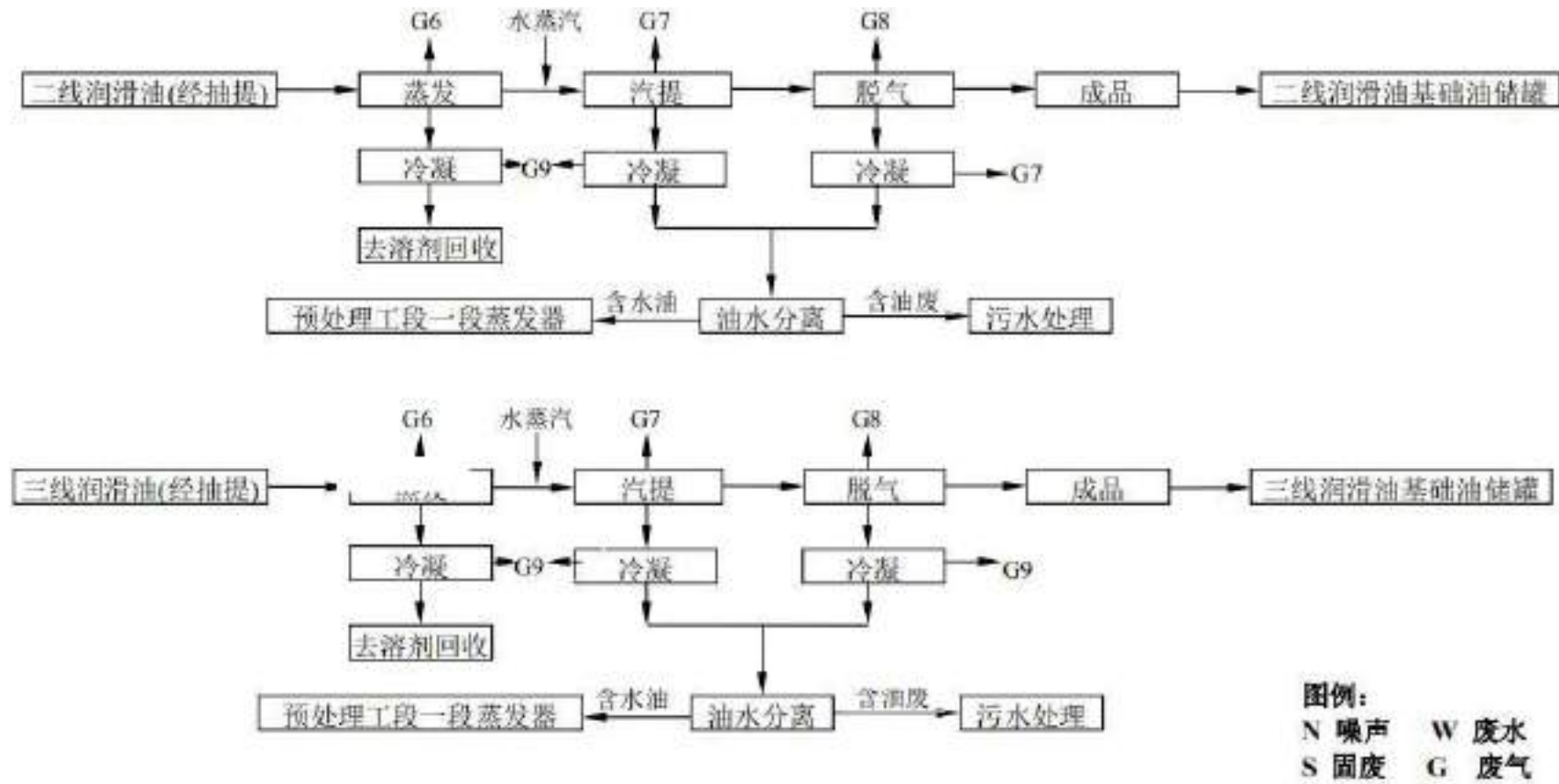
图 4.1-3 精制工段生产工艺流程及产排污节点图
