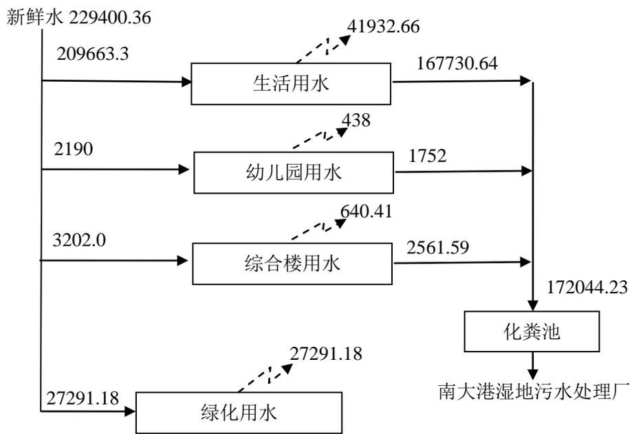
图 1 项目用、排水平衡图 单位: m<sup>3</sup>/a
