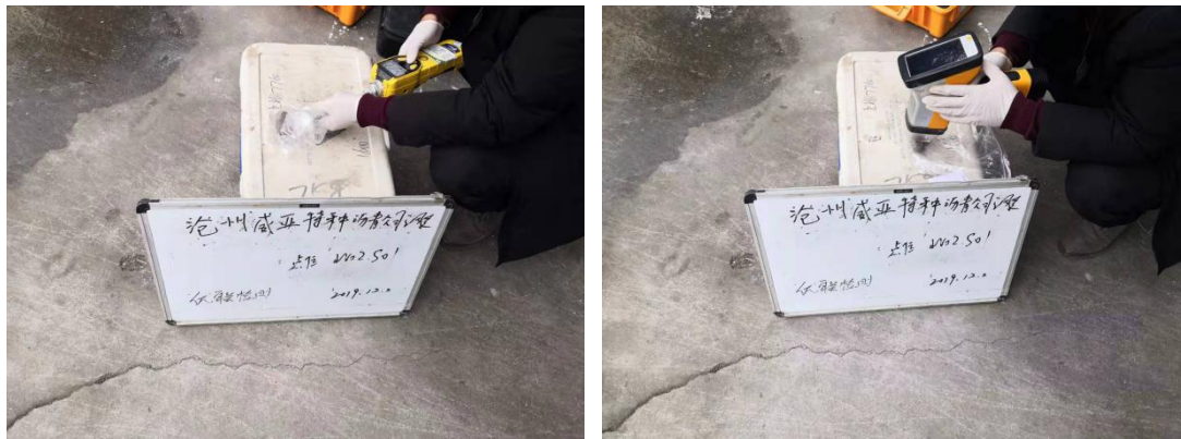
图 4.4-2 PID 和 XRF 现场测定示意图
