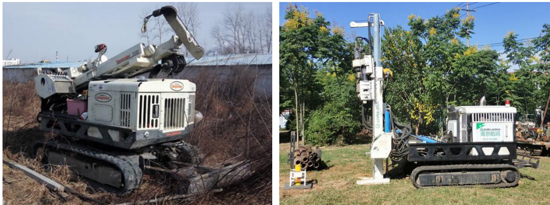
图 4.4-1 Geoprobe 与 eprobe 系列钻机
